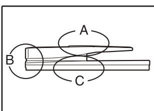
检查左侧图示所示的 A、B 和 C 区域，清除卡住的原稿。
