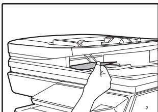
如果卡住的原稿难以从输出区清除，打开送纸辊盖板，打开送稿器托盘并取出原稿。
