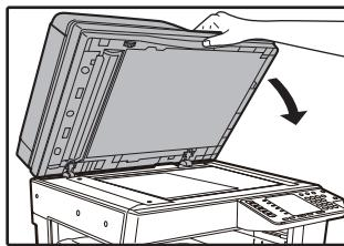
放置原稿之后，确保关闭原稿盖板 / RSPF。如果保持打开，原稿以外的部分将被复印成黑色，导致墨粉浪费。
