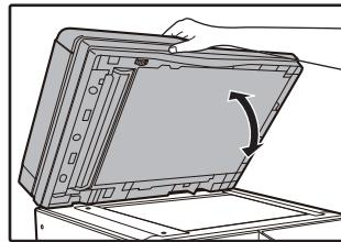
你也可以通过打开和关闭送纸辊盖板来使卡纸指示灯停止闪烁。
