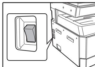
如果在机器运行时关闭电源开关，则可能发生卡纸并且正在进行的任务将会被取消。
