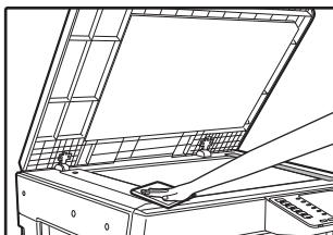
原稿台 / RSPF 上的污点或污迹也会被复印。使用柔软干净的抹布清洁原稿台、原稿盖板 / RSPF 内面和原稿台的扫描条。
