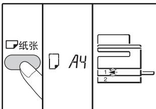
当前选择的送纸位置指示灯将闪烁，且相应的纸张尺寸（当前设置）指示灯将显示。
