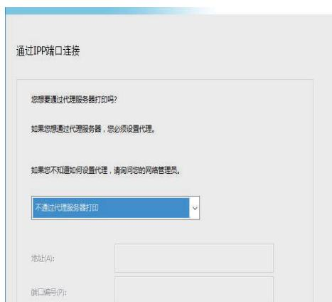
\*3 通常端口号和前置冒号“:”可以省略。如果机器SSL/TLS的IPP端口号更改，输入该新端口号。
