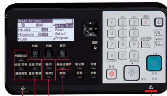
绿色 LED 状态灯 传真功能键 扫描程序键 卡片复印键 红色 LED 状态灯
